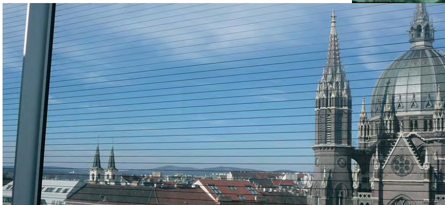
Perception obtenue grâce à des lignes noires horizontales d'une épaisseur de 2 mm avec un espace de 28 mm
